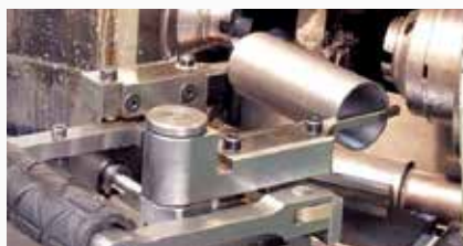
Ponçage des surfaces de contact des segments
