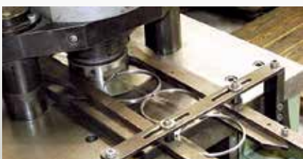
Machine d'alésage interne – Production des contours intérieurs
