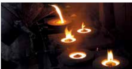
Coulée des segments bruts (en coquilles)
