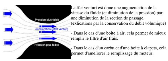
Ne croyez pas toujours qu'un rétrécissement d'une section équivaut à une bride ; l'effet venturi, c'est ce qui fait les performances d'un moteur, ne l'oubliez pas.
