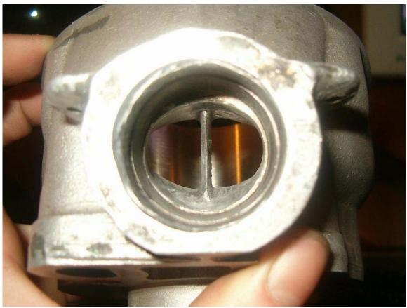
Sur ce piston, dont on a coupé la jupe, on note les deux petites amorces de perçage de 1.5mm, destinées à accumuler de l'huile pour améliorer le graissage. Ne pas percer en face d'une lumière.
