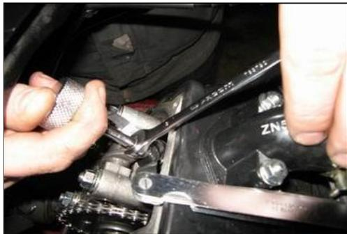
Réglage de la vis avec la cale prise en sandwich et resserrage du contre écrou.
