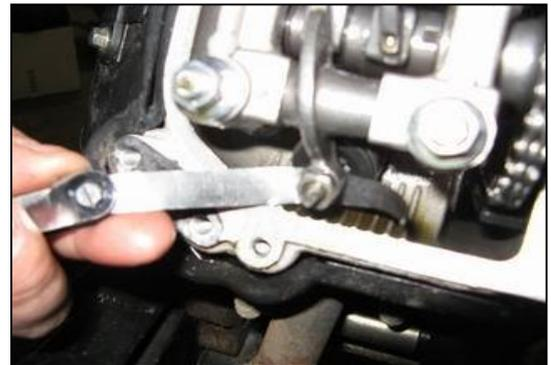
Après le resserrage des contre écrous des vis de réglage, il est préférable de reconstrôler le jeu aux soupapes.
