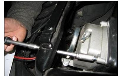
3- Positionner le piston au "**point mort haut**", pour cela il faut :
