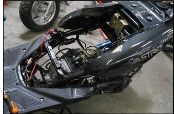
2- Déposer le cache turbine coté volant moteur, sortir la bougie et déposer le cache culbuteur
