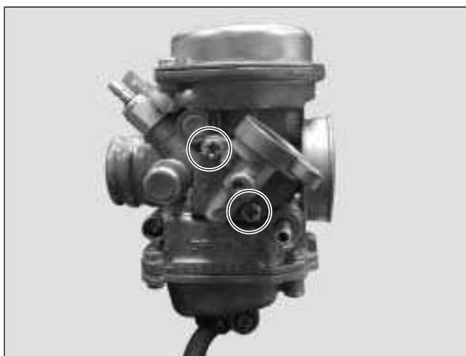
Dépose du réchauffeur de carburateur
