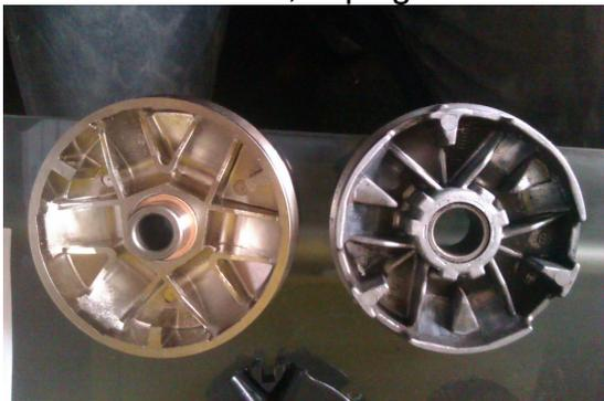
Dans ce cas, il faut mettre une courroie plus longue pour qu'elle monte plus haut, sinon il ne sera pas exploité, puisqu'une courroie de taille standard ne peut pas monter plus haut car elle est à fond dans le correcteur, et donc = toujours la même pointe.
