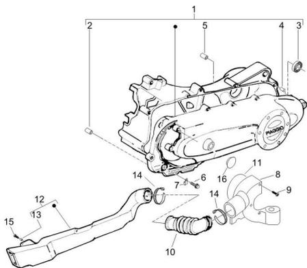
TAB. 01.15 - Couvercle volant magnetique - Filtre à huile
