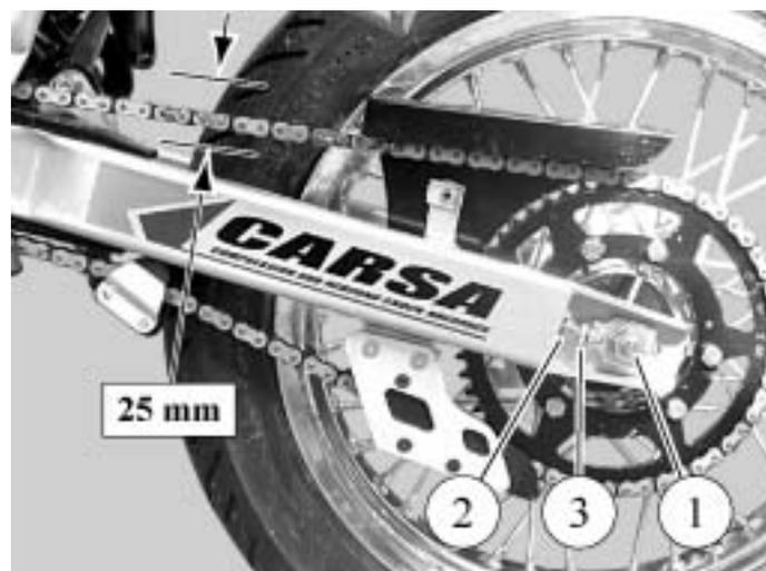
**Nota :** Une chaîne trop tendue provoque une usure rapide du roulement d'arbre de sortie de boîte, des roulements de roue arrière, de la chaîne et des pignons
