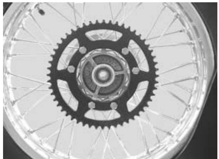
**Nota :** Le remplacement de la couronne devra être effectué en même temps que l'échange du pignon de sortie de boîte et de la chaîne
