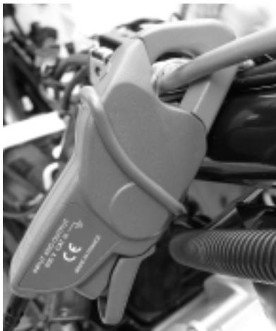
Positionner la pince ampèremétrique sur le câble de puissance entre la batterie et le contacteur principal.
