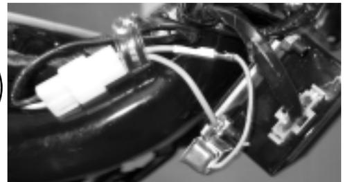
Entre les bornes du connecteur mesurer la résistance qui doit être de  $1 \pm 20\% \Omega$ .
