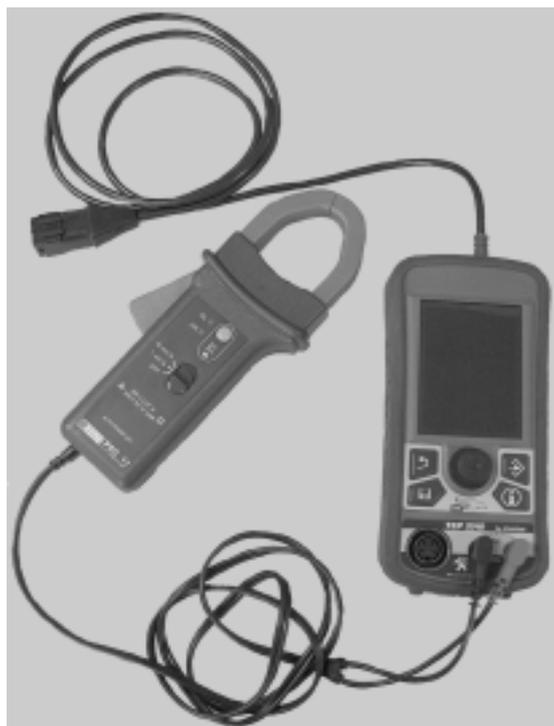
Brancher une pince ampèremétrique pour courant alternatif sur le TEP2010 et régler le multimètre sur le calibre approprié. (Suivant le modèle de pince)
