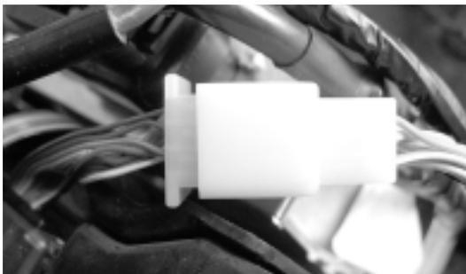
Les contrôles électriques de l'ensemble de chaînage peuvent être réalisés au niveau du connecteur entre le faisceau et la nappe du module N°1.
