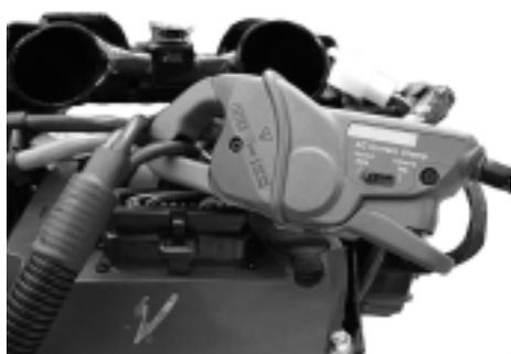
Positionner la pince ampèremétrique sur une des phases. Répéter la mesure pour les autres phases.
