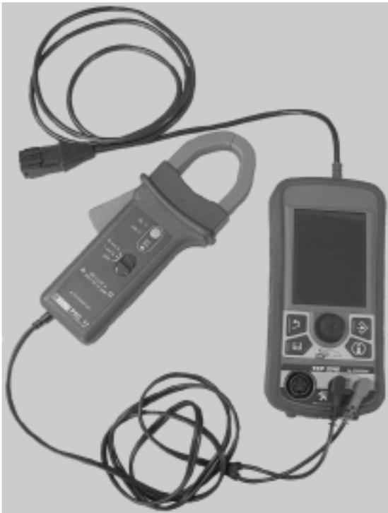
Brancher une pince ampèremétrique pour courant continu sur le TEP2010 et régler le multimètre sur le calibre approprié. (Suivant le modèle de pince)
