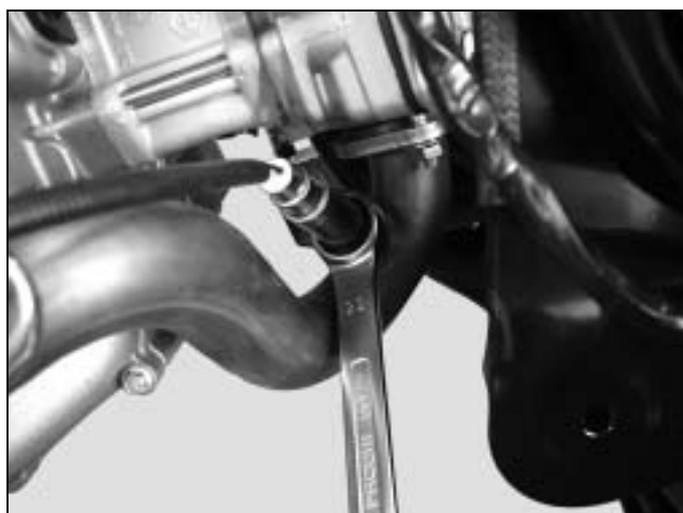
**Nota : Au remontage, graisser le filetage (A) de la sonde avec de la graisse graphitée.**
