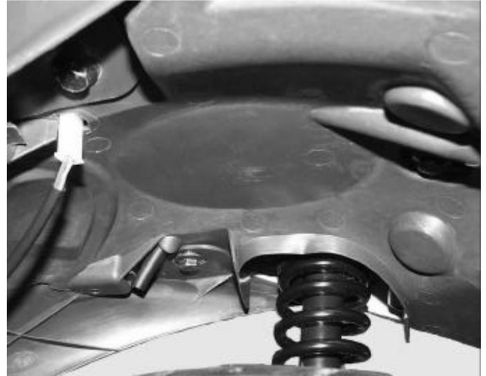
Fixer le marchepied sur le châssis (4vis)
