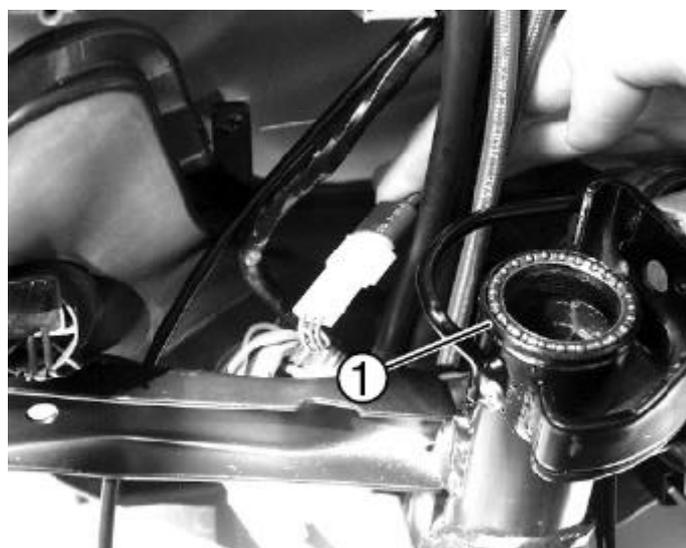
Dépose du cône inférieur de fourche
