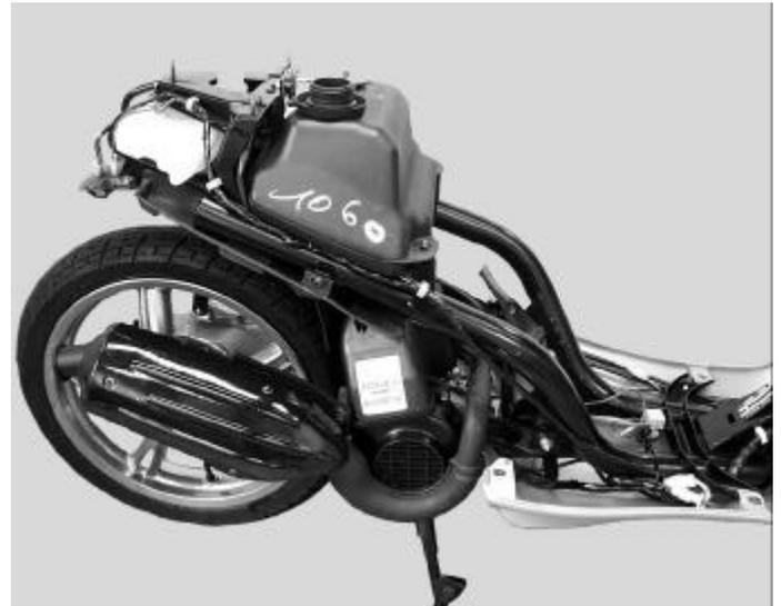
Déposer le boîtier ACI 100 (1), 2 vis (100cc)
