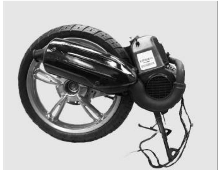
🖐 Lors de la repose du groupe motopropulseur la première opération à réaliser est de connecter les tuyaux de pompe à huile (1) (2) préalablement passés dans le protecteur plastique (3)
