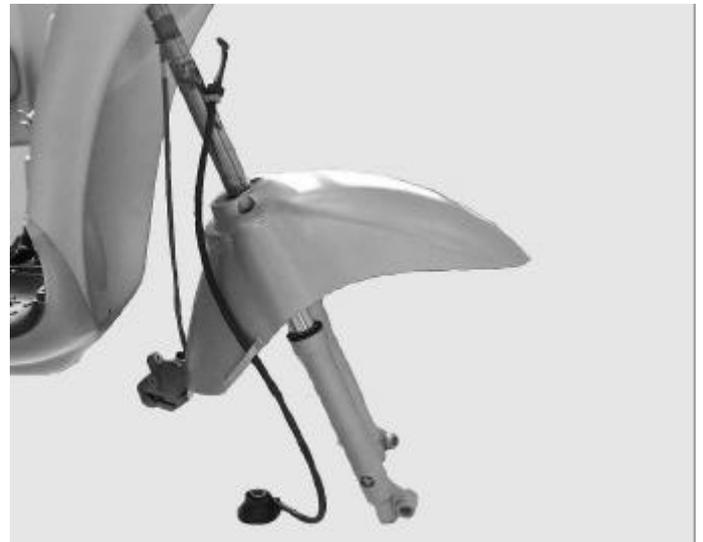
Déposer les 3 vis (1) du garde-boue avant
