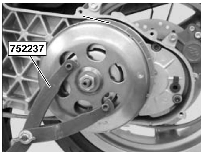
Dépose de l'ensemble mâchoires d'embrayage.
