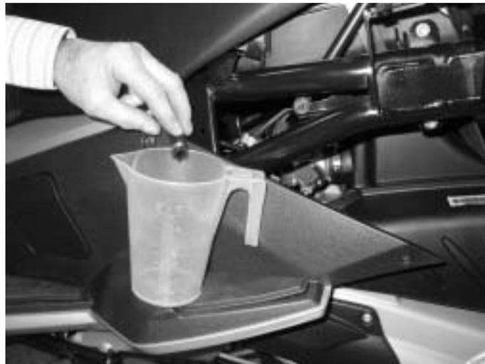
5. Débrancher le tuyau de l'injecteur de carburant et le mettre dans un récipient gradué.
