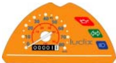
L'allumage du témoin d'huile au combiné informe le conducteur de la présence de défaut sur la fonction électrique du système ou du niveau mini d'huile dans le réservoir.
