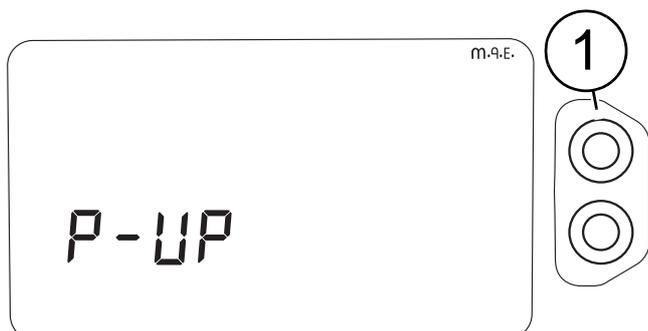
L'afficheur demande le système d'allumage utilisé sur le véhicule en passant alternativement de l'indication «P-UP» à «no P-UP».
