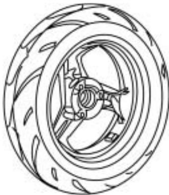
Un gonflage incorrect des pneus se traduit par une usure anormale de la bande de roulement et nuit à la sécurité (éclatement, déjantage).
