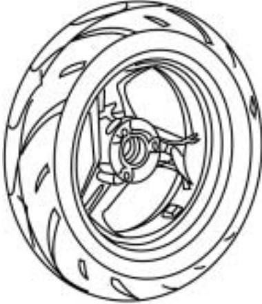
Contrôler fréquemment la pression de gonflage et l'ajuster si nécessaire.
