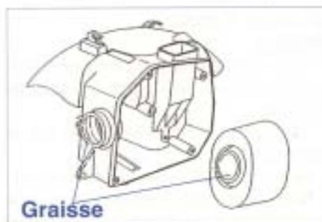
Attention : il est impératif que tous les éléments du filtre soient en place et bien positionnés. Toute modification du circuit d'air est préjudiciable au bon fonctionnement du moteur;
