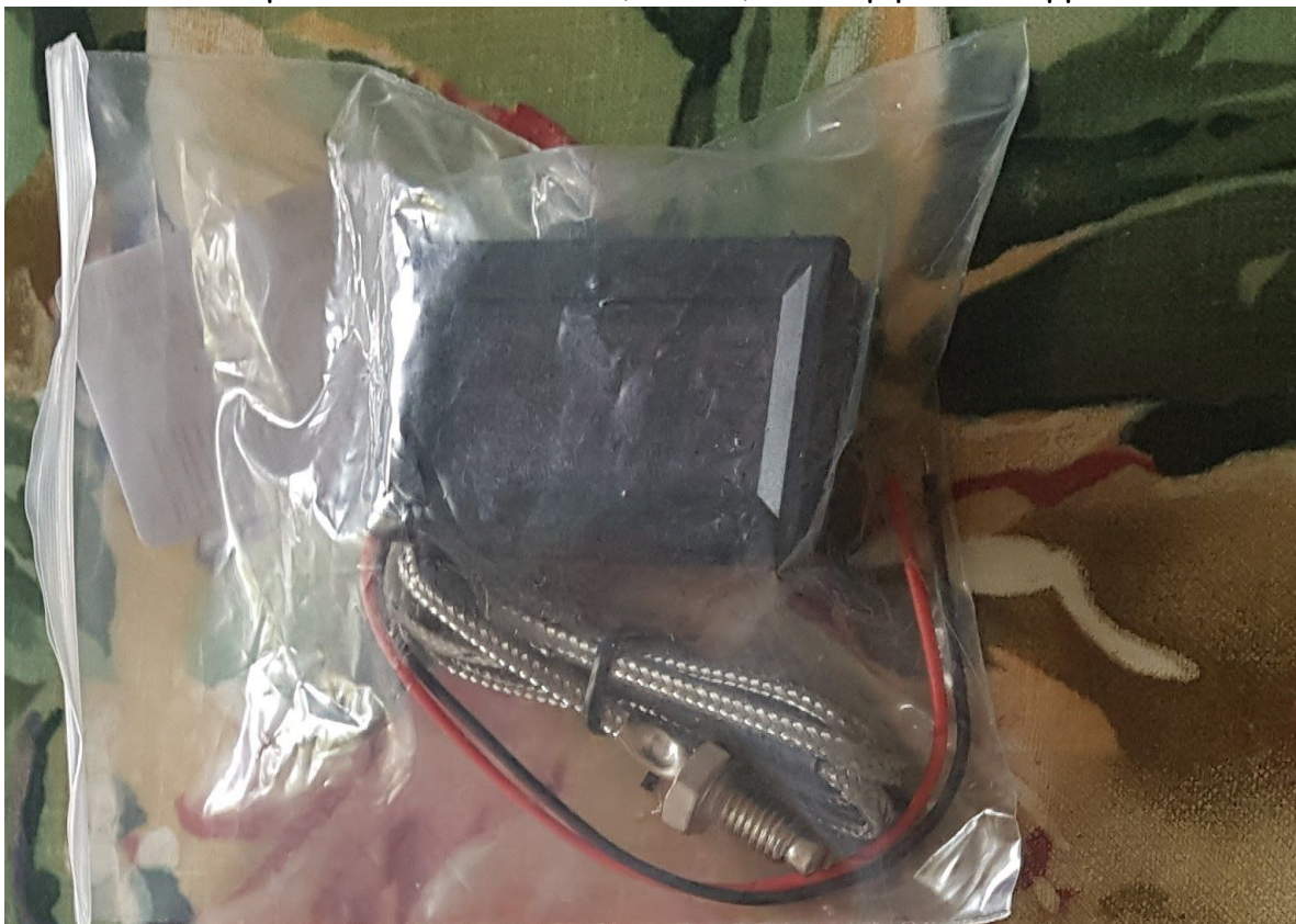
La sonde de température industrielle ( >800^{\circ}\text{C} ) sur la pipe d'échappement :
