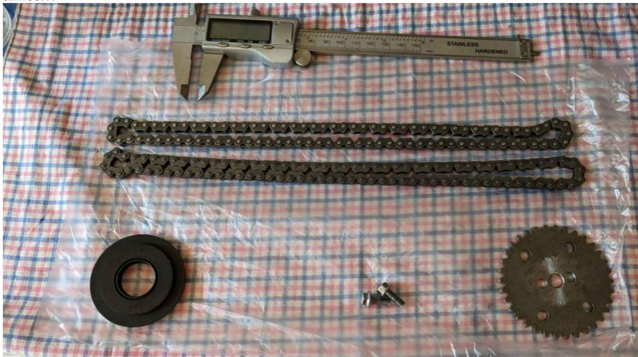
Elle paraît légèrement plus longue, mais en fait elle va s'avérer trop longue pour le tendeur ! Donc il m'a fallu supprimer le joint de 0,5mm du tendeur, remplacé par de la pâte à joint, et ajouter une petite rondelle inox dans la tête du tendeur.
