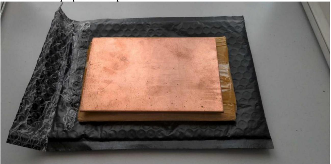
Là, c'est du laminé, donc il est très dur... Pour le ramollir, il faut se munir d'une torche, le chauffer au rouge, et le jeter dans l'eau froide !... si si !... c'est l'inverse de l'acier, qui lui, se durcit quand on le refroidit par trempage. Maintenant, on a un matériau relativement facile à découper.
