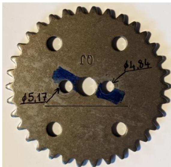
Donc celui qui va recevoir les 0,7mm de décalage, c'est celui de droite, de 4,84mm de diamètre : en effet, la vis de fixation de 5mm passe tout juste dedans.
